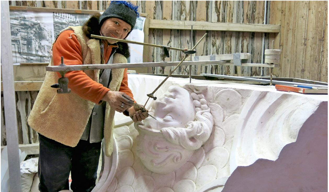
Mit dem Punktiergerät wird das Maß des 1:1 Modells aus Gips auf den Sandsteinblock übertragen.
