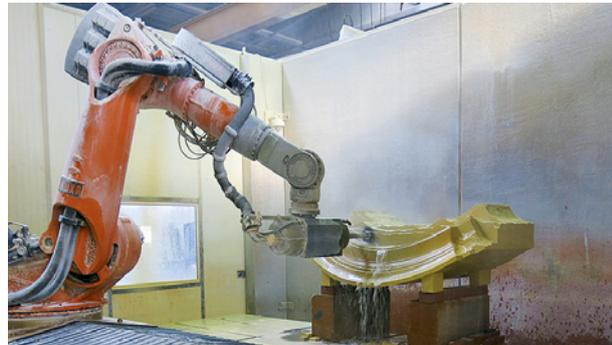
Der Roboter fräst die Verdachung des Bukranionfensters.
